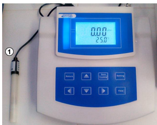
Рис. 8. Цифровой кондуктометр с погружным двухэлектродным кондуктометрическим датчиком 1 .
