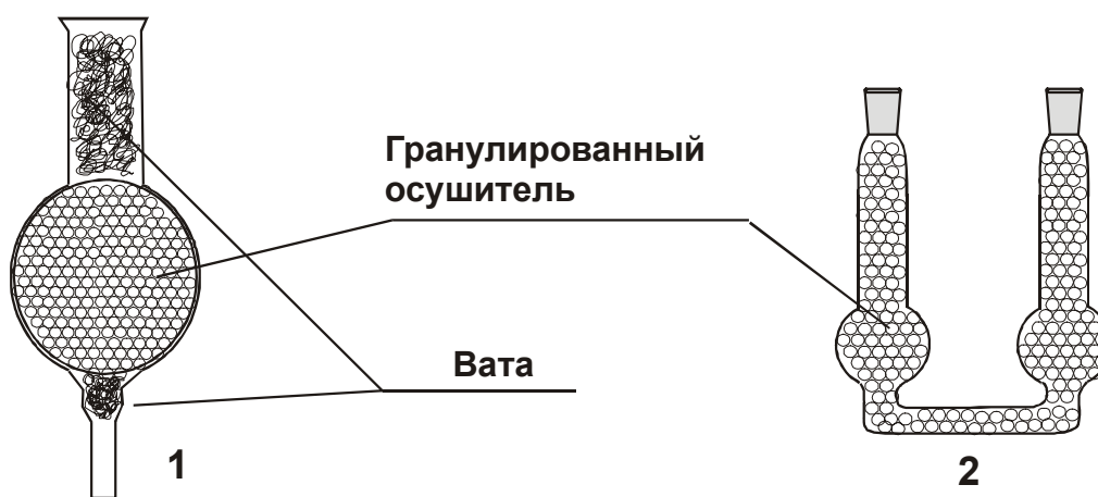
Рисунок 9. Осушительные трубки: 1 - хлоркальциевая трубка с одним шаром; 2 - U-образная трубка (обычно используется для осушки потока газа)
