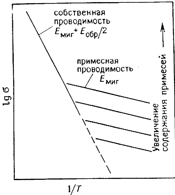
Рис. 13.2. Зависимость ионной проводимости NaCl от температуры (схема). Параллельные линии в примесной области соответствуют различной концентрации легирующих примесей.
