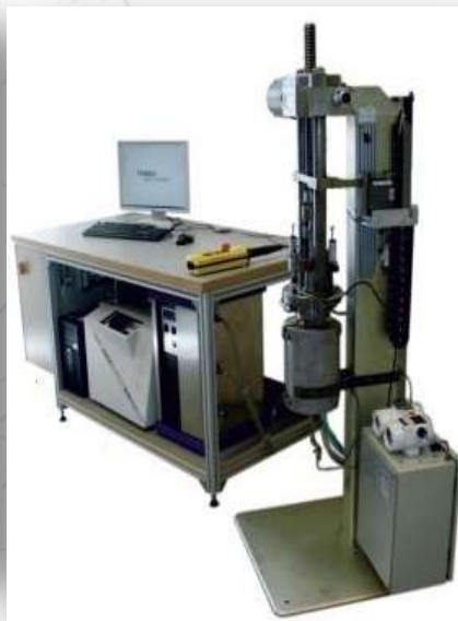
Испытательный центр для определения параметров герметичности динамических узлов Amtec Temes freak
