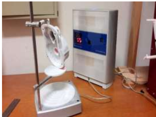
3D-сканер NextEngine 3D Scanner HD 3D-разрешение - от 150 dpi до 400 dpi. Точность: 0,127 - 0,381 мм
