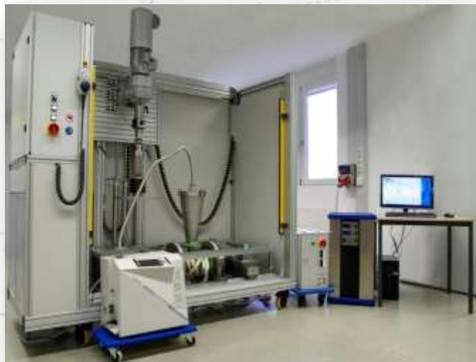
Испытательный центр для запорной и регулирующей арматуры Amtec Temes valve (DN150/PN250, DN250/PN25)
