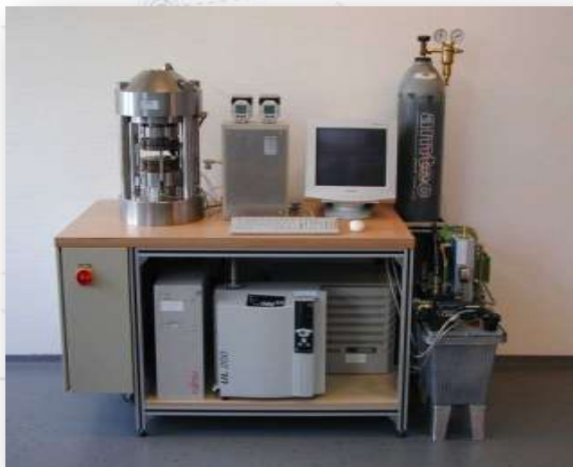
Испытательный центр для определения герметичности фланцевых соединений Amtec Temes Fl.ai
